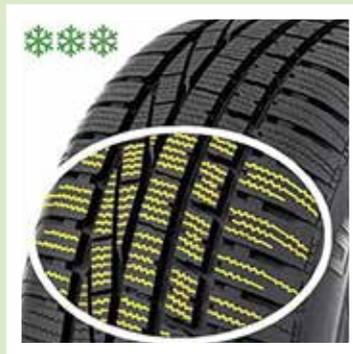
Das Profil von Winterreifen mit den Profilschnitten, „Lamellen“ genannt.
