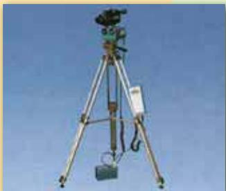
Verkehrsmesssystem „LEICA XVS“ geeignet für den schnellen Messpunktwechsel
